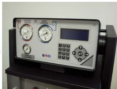
PANEL STERUJĄCY URZĄDZENIA OBSŁUGOWEGO Z MANOMETRAMI DO R1234YF, OZNAKOWANIEM KRYTERIÓW RYZYKA I KOMPUTEREM WSPOMAGAJĄCYM OBSŁUGĘ
