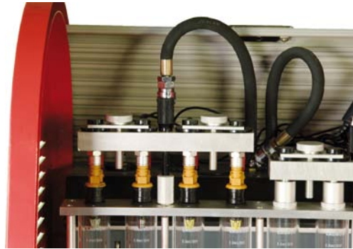
LISTWA ZASILAJĄCA PALIWEM TESTOWANE WTRYSKIWACZE
