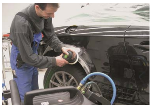
USUWANIE ŚLADÓW ZGRZEWANIA BITÓW PO ZAKOŃCZONYM PROSTOWANIU WGNIECENIA
