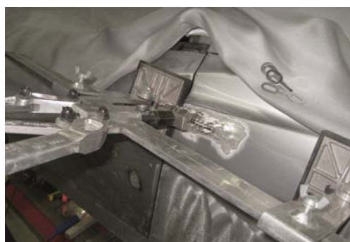
RÓWNOCZESNE CIĄNIĘCIE KILKU BITÓW RĘCZNYM MECHANIZMEM DŹWIGNIOWYM (LINE-PULLER)
