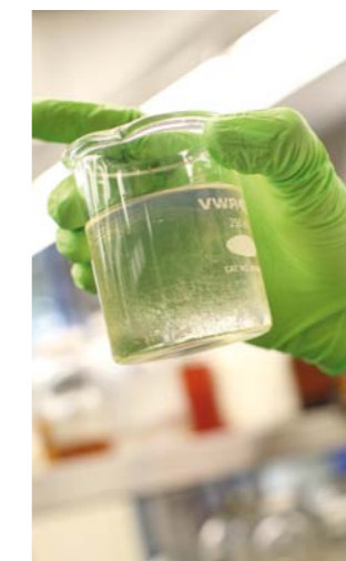
BADANIE ROZPUSSZALNOŚCI OLEJÓW METODĄ TWORZENIA PRÓBNYCH ROZTWORÓW
