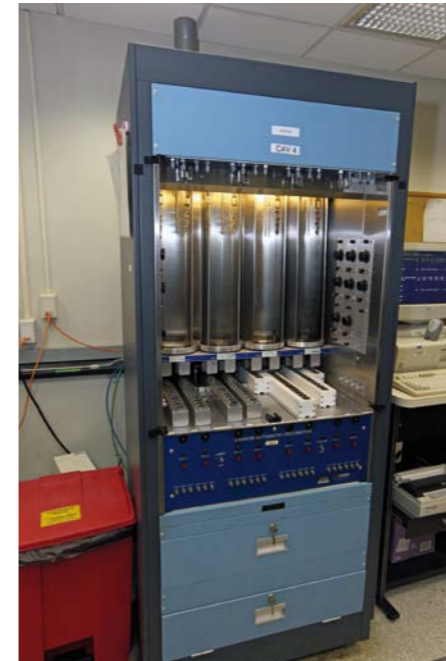
STANOWISKA LABORATORYJNE DO: – AUTOMATYCZNEGO BADANIA LEPKOŚCI KINEMATYCZNEJ ZGODNIE Z NORMĄ ASTM D445 (U GÓRY Z LEWEJ) – ROTACYJNEGO BADANIA LEPKOŚCI WEDŁUG NORMY MRV – ASTM D4684 (U GÓRY Z PRAWYJ) – POMIARU TEMPERATURY PEŁNIENIA OLEJÓW WEDŁUG NORMY ASTM D97 (U DOŁU Z PRAWYJ)
