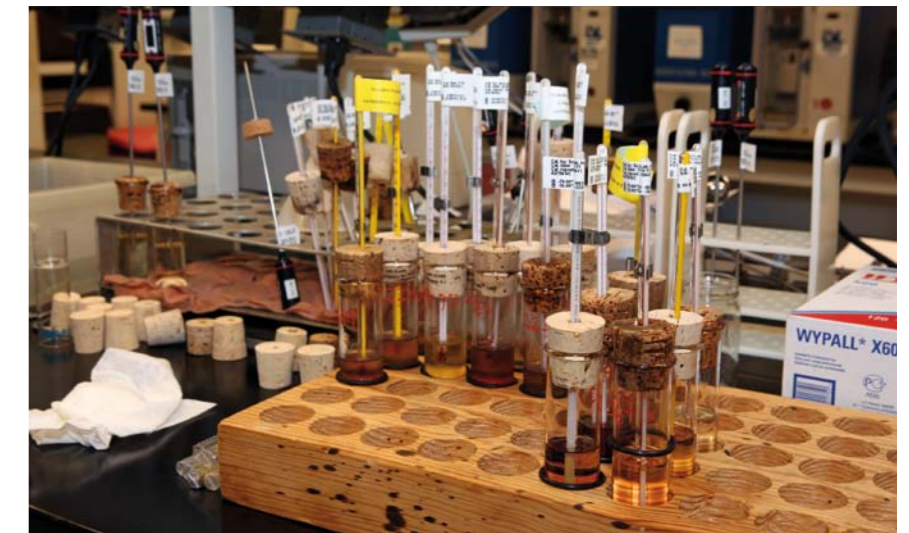
STANOWISKA LABORATORYJNE DO: – AUTOMATYCZNEGO BADANIA LEPKOŚCI KINEMATYCZNEJ ZGODNIE Z NORMĄ ASTM D445 (U GÓRY Z LEWEJ) – ROTACYJNEGO BADANIA LEPKOŚCI WEDŁUG NORMY MRV – ASTM D4684 (U GÓRY Z PRAWYJ) – POMIARU TEMPERATURY PEŁNIENIA OLEJÓW WEDŁUG NORMY ASTM D97 (U DOŁU Z PRAWYJ)
