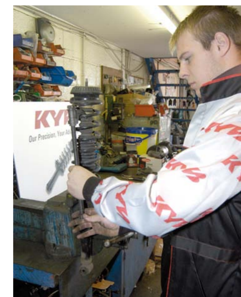
PRZY DEMONTAŻU USZKODZONEJ KOLUMNY RESORUJĄCEJ KONIECZNE JEST UŻYCIEM NAPINACZA ŚRUBOWEGO
