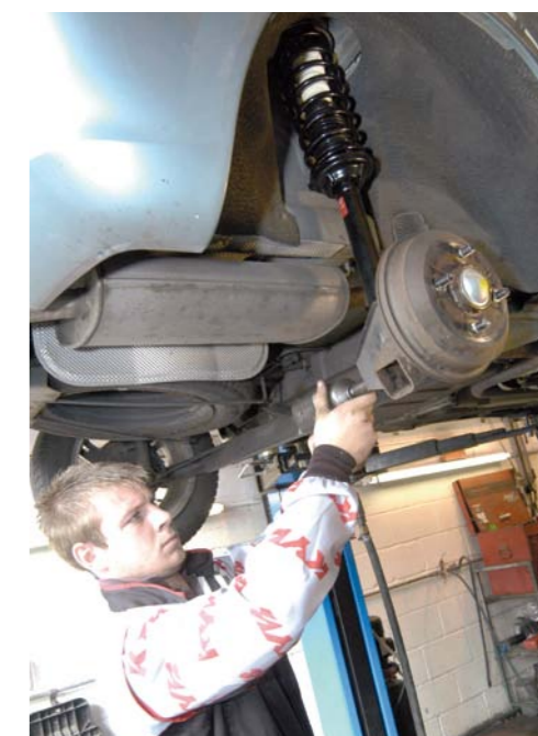
USZKODZONE AMORTYZATORY NADAJĄ SIĘ WYŁĄCZNIE DO WYMIANY CAŁEGO ICH KOMPLETU DLA DANEJ OSI
