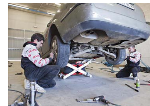
PROFESJONALNA KONTROLA ZAWIESZEŃ WYMAGA PODNIESIENIA SAMOCHODU I ZDEMONTOWANIA KÓŁ
