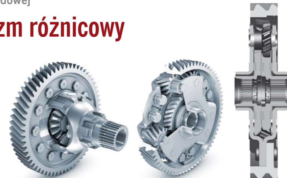
OD LEWEJ: KLASYCZNY MECHANIZM RÓŻNICOWY ZE STOŻKOWYMI KOŁAMI ZĘBATYMI. LEKKA KONSTRUKCJA MARKI INA Z ZASTOSOWANIEM ZĘBATYCH KOŁ WALCOWYCH. ZMNIJSZENIE GABARYTÓW WIDOCZNE NA PRZEKROJU MECHANIZMU INA
