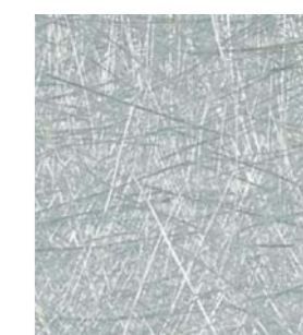
WŁÓKNA SZKLANE CIĘTE O ŚREDNICY 13-15 MIKROMETRÓW
