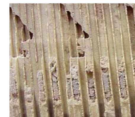
ZABLOKOWANIE WKŁADU POPIOŁEM z dodatków uszlachetniających oleju
