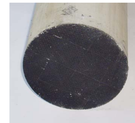
WKŁAD DPF niemal całkowicie niedrożny, wymagający wymiany
