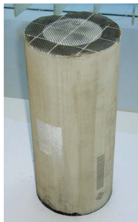
CERAMICZNY WKŁAD FILTRUJĄCY IZOLOWANY TERMOWŁÓKNINĄ, UMIESZCZANY W METALOWEJ OBUDOWIE
