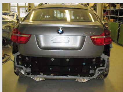
Udział klejenia i nitowania w wymianie bocznego poszycia tylnej części nadwozia
