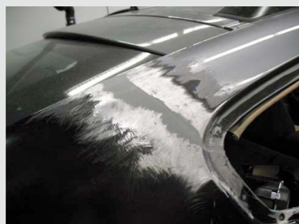
Udział klejenia i nitowania w wymianie bocznego poszycia tylnej części nadwozia
