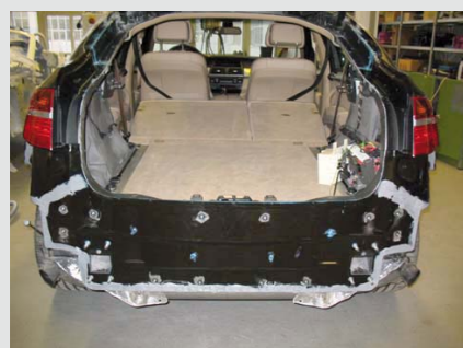
Wymieniony pas tylny zamocowany nitami ustalającymi i klejem na obwodzie
