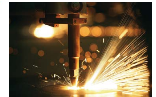
ZMECHANIZOWANE CIĘCIE TLENEM
