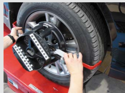
Zaklinowanie pazurów przyciskiem blokującym
