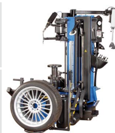
UNIERSALNE MONTAŻOWNICE HOFMANN Z WYPOSAŻENIEM DO OBSŁUGI KOŁE TYPU PAX (RYS. 1 I 2) ORAZ RUN ON FLAT (RYS. 3 I 4). Z PRAWY: NAJNOWOCZĘSNIJSZY MODEL QUADRIGA Z CAŁKOWICIE AUTOMATYCZNYM WYBÓREM FUNKCJI
