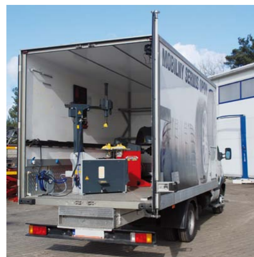
SAMOCHÓD MOBILNEGO SERWISU OGUMIENIA Z WŁASNĄ AGREGATĄ PRĄDOTWÓRCZĄ I MOŻLIWOŚCIĄ PODŁĄCZENIA DO SIECI ENERGETYCZNEJ
