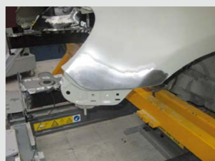
Oczyszczone i odtłuszczone podłożo
