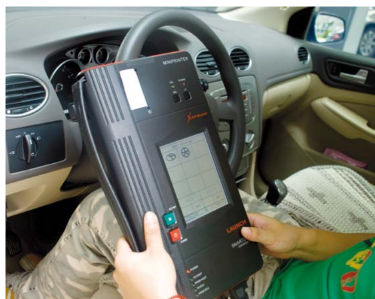
TESTER DIAGNOSTYCZNY X-431 JEST ZNANYM I NAJCZĘŚCIEJ UŻYWANYM W WARSZTATACH NA CAŁYM ŚWIECIE URZĄDZENIEM DO DIAGNOZOWANIA ELEKTRONICZNYCH UKŁADÓW STERUJĄCYCH W POJAZDACH SAMOCHODOWYCH
