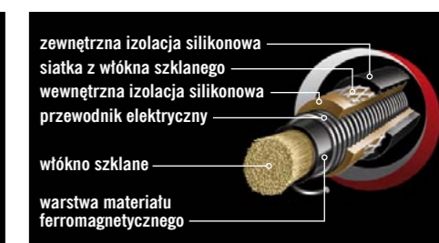
PRZEWODY ZAPŁONOWE W IZOLACJI SILIKONOWEJ, Z LEWEJ: Z RDZENIEM MIEDZIANYM (LUB WĘGLOWYM), Z PRAWEJ: KONSTRUKCJA TYPU WIRE WOUND
