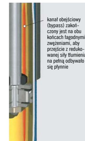
ZASADA I SKUTKI DZIAŁANIA AMORTYZATORA O ZMIENNEJ CHARAKTERYSTYCE TŁUMIENIA. SKONSTRUOWANEGO W ZAKŁADACH SACHS W LATACH MIĘDZYWOJENNYCH
