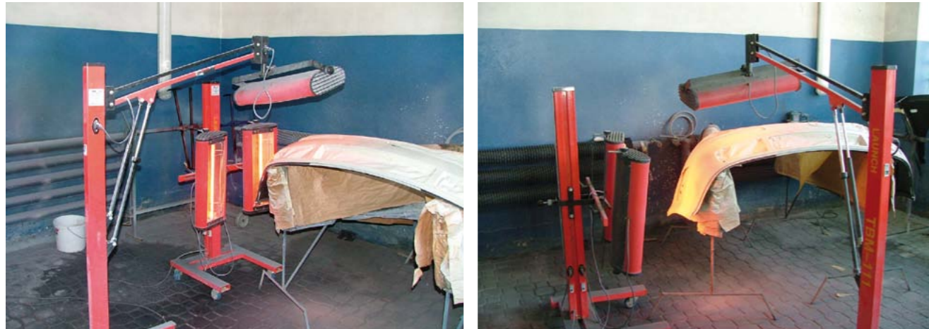
ODPOWIEDNIE KONFIGURACJE MOBILNYCH PROMIENNIKÓW POZWALAJĄ TWORZYĆ NAJLEPSZE POD WZGLĘDEM TECHNICZNYM I EKONOMICZNYM WARUNKI DO SUSZENIA POJEDYNCZYCH ELEMENTÓW NADWOZI
