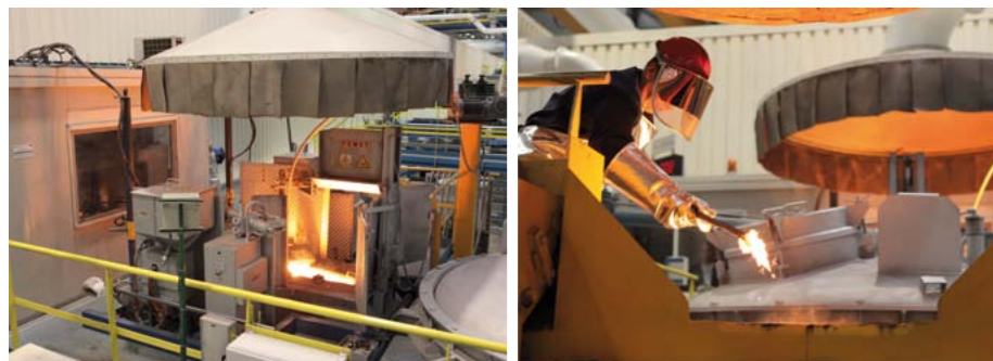
INDUKCYJNE PIECE DO WYTOPU ŻELIWA NIE POWODUJĄ LOKALNEJ EMISJI DWUTLENKU WĘGLA. A GAZY I OPARY WYDZIAŁAJĄCE SIĘ ZE STOPÓW ODLEWNICZYCH ZATRZYMUJE NOWOCZESNY SYSTEM FILTRACJI
