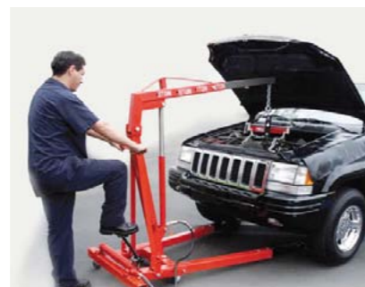
RAMIENIOWY HYDRAULICZNY ŻURAW WARSZTATOWY DO WYJMOWANIA SILNIKA Z POJAZDU (KU GÓRZE LUB DO PRZODU)
