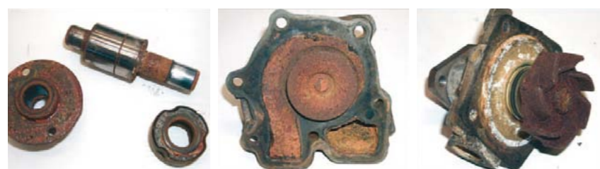
SKUTKI STOSOWANIA NIEWŁAŚCIWEGO PŁYNU CHŁODZĄCEGO
