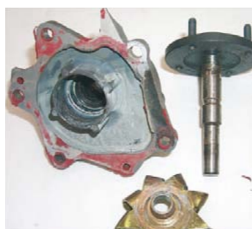
USZKODZENIE POMPY Z POWODU NADMIERNEGO LUB NIEREGULARNEGO OBCIĄŻENIA JEJ ŁOŻYSKOWANIA
