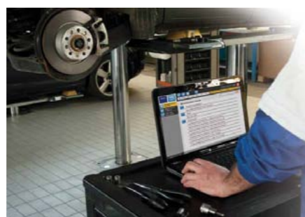
INTERFEJS NANOSERVICE KOMUNIKUJE SIĘ ZE STEROWNIKAMI PRZEZ GNIAZDO OBD I BEZPRZEWODOWO Z KOMPUTEREM PC
