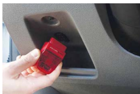
INTERFEJS NANOSERVICE KOMUNIKUJE SIĘ ZE STEROWNIKAMI PRZEZ GNIAZDO OBD I BEZPRZEWODOWO Z KOMPUTEREM PC
