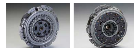
WIDOK PODWÓJNEGO SPRZĘGŁA OD STRONY SILNIKA (Z LEWEJ) I SKRZYNI BIEGÓW
