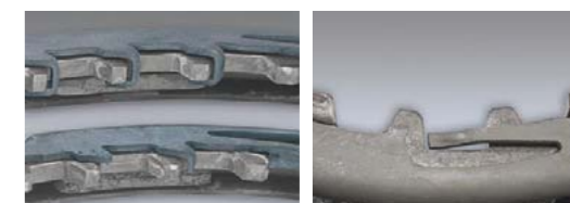
ZERWANE ZACZEPY USTALAJĄCE NA PIERŚCIENIU NAPINAJĄCYM DWUMASOWEGO KOŁA ZAMACHOWEGO
