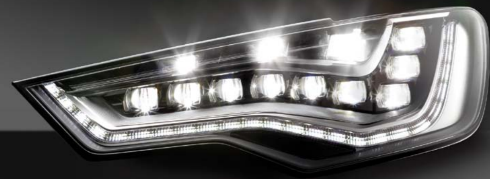
REFLEKTOR AUDI A6, WYKONANY CAŁKOWICIE W TECHNOLOGII LED
