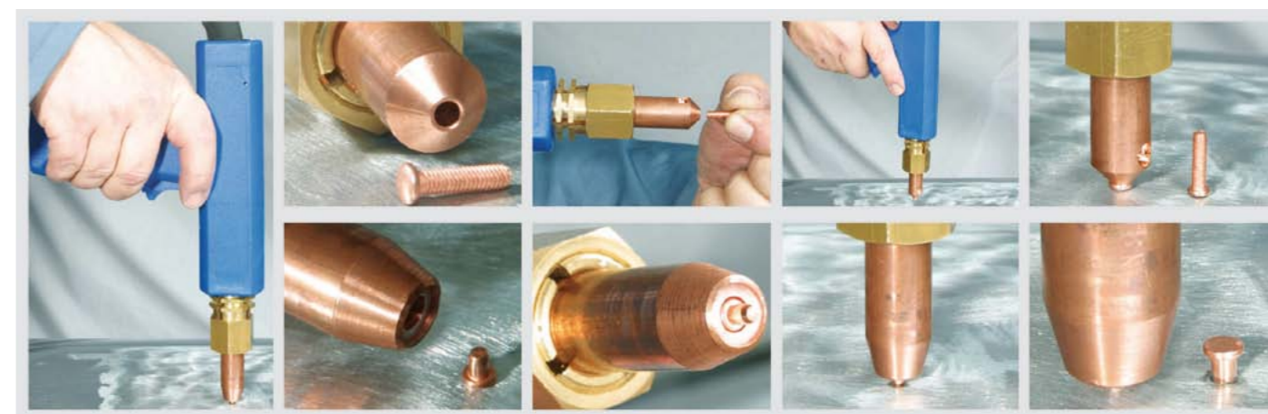
FOT. 5. PRZYGRZEWANIE ELEMENTÓW DO KAROSERII PRZY ZASTOSOWANIU SPOTTERA EZSPOT 3500A (EZ-DENT)
