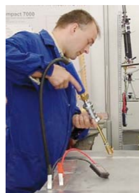
FOT. 1. SPOTTERY POZWALAJĄ NA ZMINIMALIZOWANIE SZKÓD PODCZAS NAPRAW BLACHARSKICH. NA KAROSERII POZOSTAJĄ TYLKO NIEWIELKIE ŚLADY
