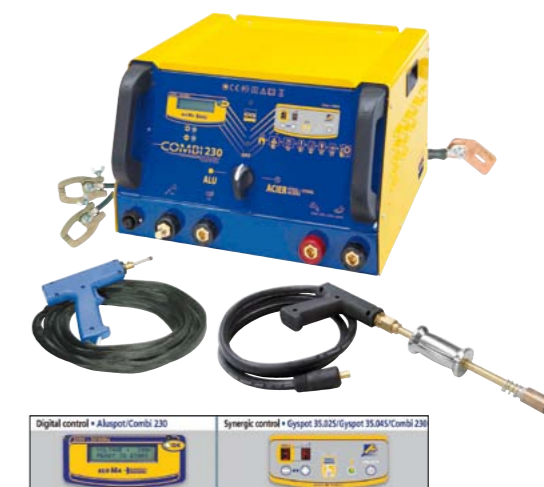
FOT. 8. NAJNOWSZY SPOTTER COMBI-SPOT (GYS) I JEGO PANELE STEROWANIA: Z LEWEJ – DO MATERIAŁÓW ALUMINIOWYCH. Z PRAWY – DO STAŁOWYCH
