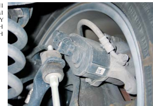
EBP W WERSJI Z INDYWIDUALNYMI SILNIKAMI PRZY ZACISKACH HAMULCOWYCH
