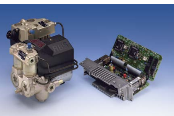
MODUŁ ABS ZE ZINTEGROWANĄ FUNKCJĄ ASR (1987 R.)
