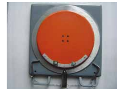
LASEROWY POMIAR ZBIEŻNOŚCI KÓŁ PRZEDNIICH Z ZASTOSOWANIEM PRECYZYJNEJ OBROTNICY (ZDJĘCIE ŚRODKOWE) I UNIWEERSALNEGO UCHWYTU GŁOWICY (Z PRAWY) UMOŻLIWIĄCEGO KOMPENSOWANIE BICIA OBRĘCZY
