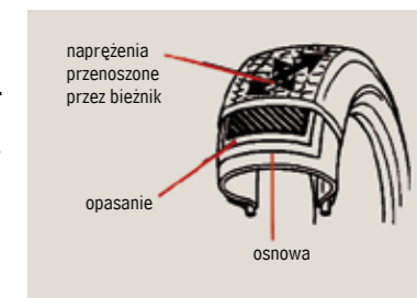
Efekt karbu – skutek warstwowej budowy opony
