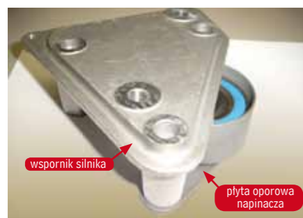
Rys. 3. Sposób mocowania starego napinacza
