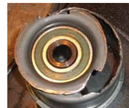
Rys. 8. Całkowicie zniszczona rolka prowadząca
