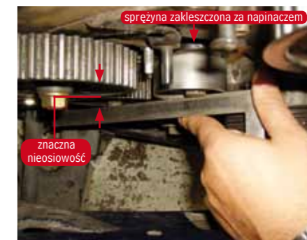
Rys. 6. Skutek błędnego zamontowania sprężyny
