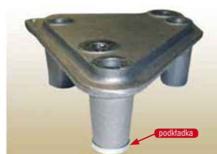
Rys. 4. Zastosowanie podkładki dystansowej
