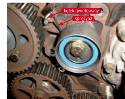
Rys. 5. Miejsce osadzenia dodatkowego kołka
