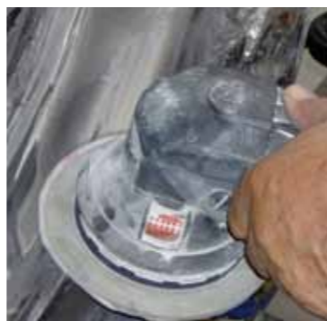
Obróbka miejsc cynowanych metodą opracowaną przez autora. Od góry: wygląd po nałożeniu cyny, formowanie zgrubne, wygładzanie
