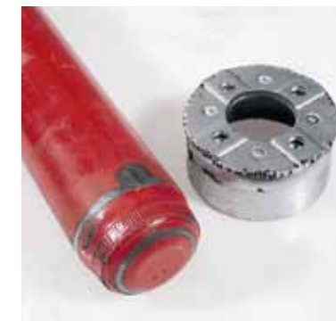
Spowodowane tarciem ubytki na wkładzie kolumny McPhersona
