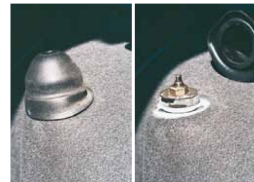
Przyczyną hałaśliwej pracy może być brak kapturka na górnym końcu tłoczyska
