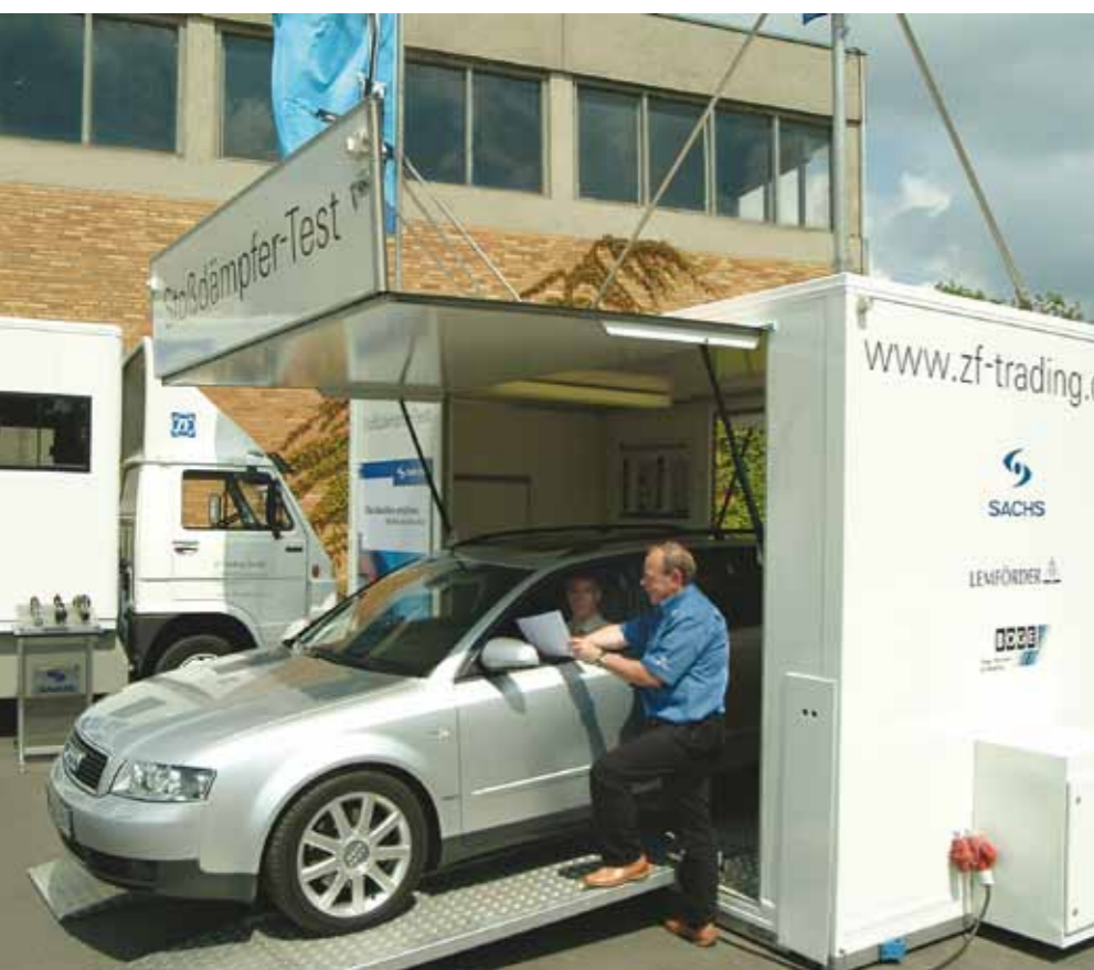
Kontrola stanu zawieszzeń specjalnym urządzeniem firmy Boge
