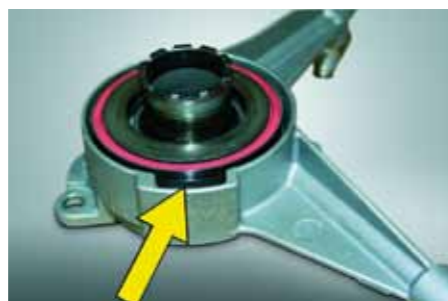
Łożysko oporowe prawidłowo osadzone w siłowniku CSC
