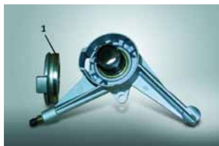
Gładka powierzchnia łożyska oporowego ma być zwrócona w stronę sprzęgła
