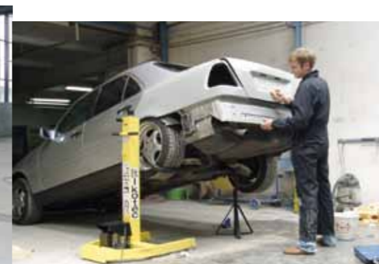
miniUPPERK – MOBILNY PODNOŚNIK ŚRUBOWY udźwig 2500 kg • 230 V • wys.podnoszenia 1 m • 6 różnych zastosowań
