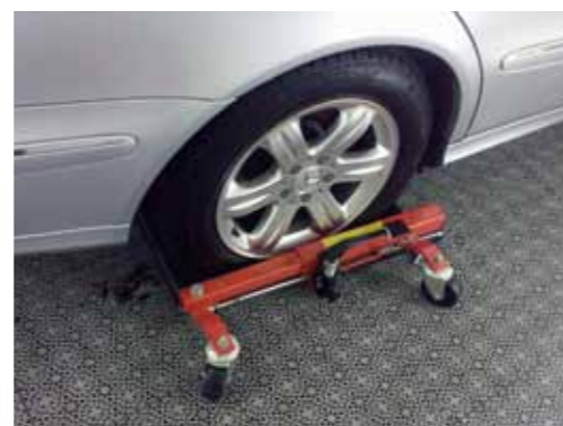
WÓZEK MANEWROWY hydrauliczny - udźwig 600 kg
