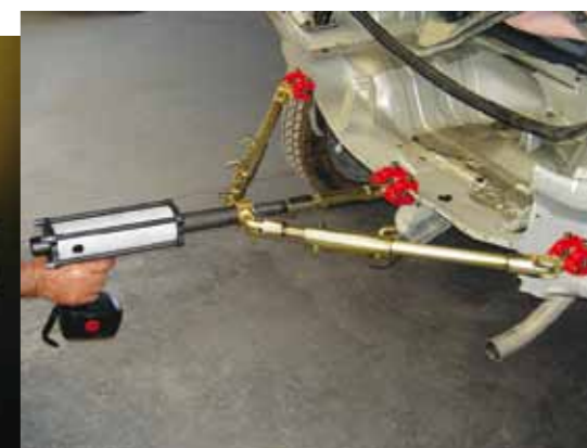
NOWOŚĆ!!! ELECTRO POWER - MOBILNY SYSTEM PROSTOWANIA KAROSERII zasilanie bateria akku 14,4 V • siła wypychania / ściągania 5 ton
