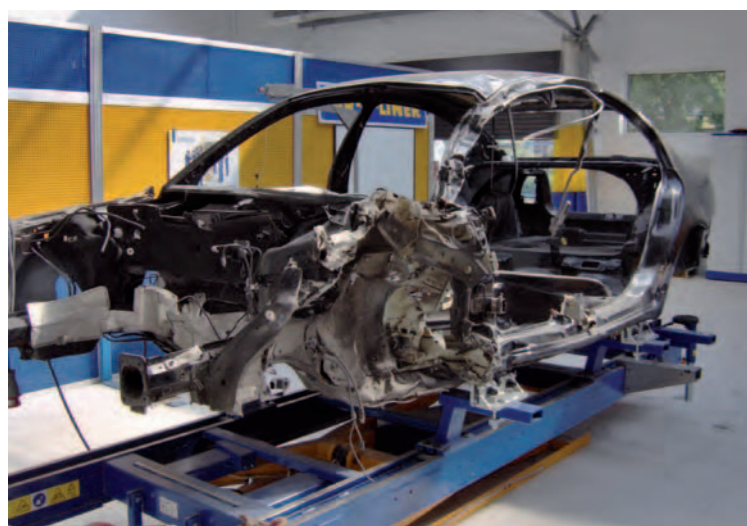
Uszkodzone nadwozie w trakcie naprawy
