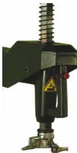
Stopka montażowa zamocowana na pionowym ramieniu montażownicy
