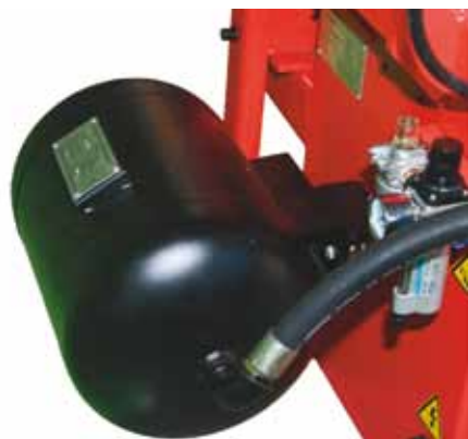
Inflator, czyli dodatkowy zbiornik ciśnieniowy do natychmiastowego napełnienia opon
