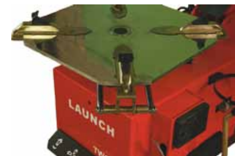
Ruchome szczęki uchwytu łączącego obręcz ze stołem obrotowym
