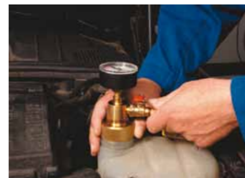
Uszczelnienie połączenia przyrządu ze zbiornikiem wyrównawczym
