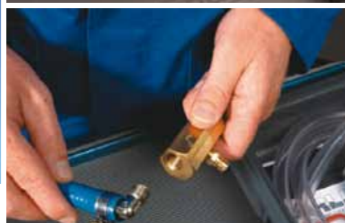
Kompletny zestaw Airlift. Z prawej, od góry: dobór końcówki gumowej, podłączanie przewodu sprężonego powietrza
