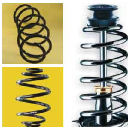
Sprężyna o charakterystyce liniowej (u góry) i progresywnej (u dołu). Obok przykład zastosowania sprężyny o jednakowych zwojach
