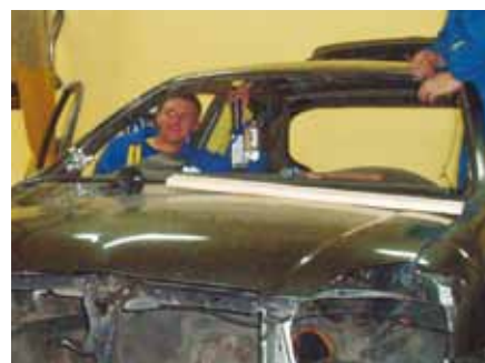
Pneumatyczny rozpieracz i drewniane podkładki pozwalają wyprostować poszycie dachu oraz wygiętą przednią belkę nadokienną
