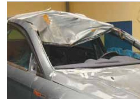
Takie uszkodzenia dachu o nowoczesnej konstrukcji nie nadają się już do naprawy. Konieczna staje się wymiana poszycia i części szkieletu
