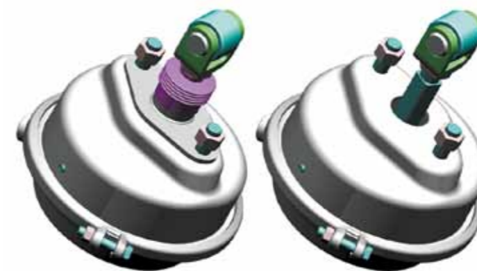
Stara (z lewej) i nowa konstrukcja siłownika pneumatycznego
