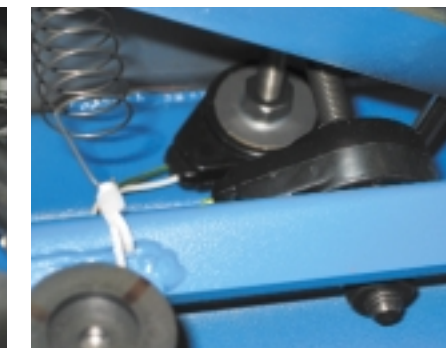
Mechanizm napędu wrzeciona wyważarki. W podporach (zjęcie z prawej) umieszczone są czujniki sił mierzone w dwu płaszczyznach
