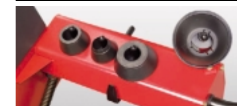
Do wyśrodkowania koła można używać tarczy z bolcami stożkowymi lub (dolne zdjęcie) jednego z wymiennych stożków do otworu centralnego felgi
