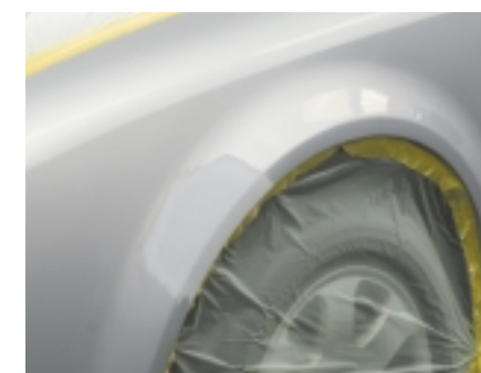
Podłożo gotowe do nałożenia nowej powłoki
