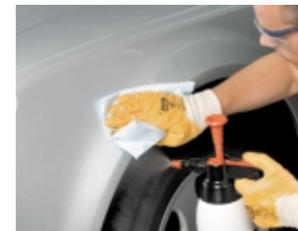
Mycie strefy uszkodzonej
