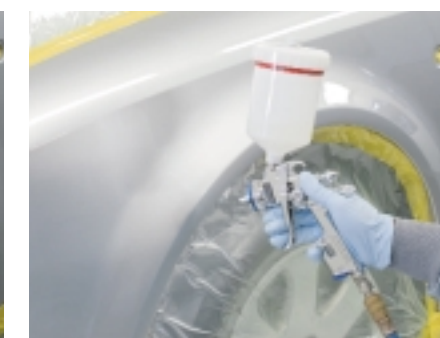
Nanoszenie lakieru bazowego i nawierzchniowego
