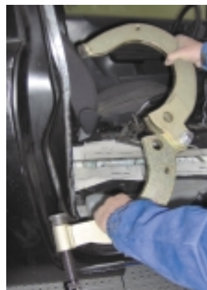
Prostowanie progu za pomocą haka wprowadzającego siłę poprzeczną
