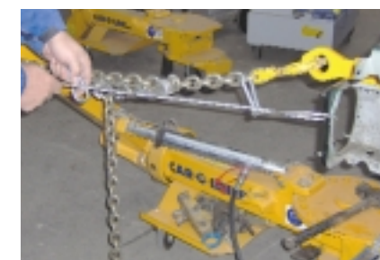
Łańcuch po lekkim naprężeniu spinamy klamrą (z lewej) i zabezpieczamy dodatkową linką (u góry)
