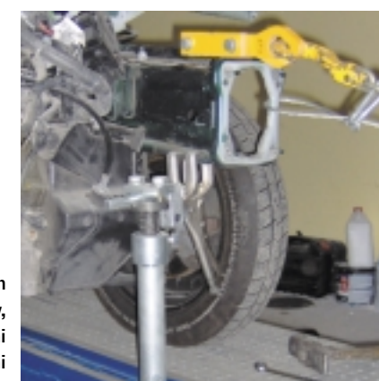
Prostowany element należy klepać młotkiem dla usunięcia naprężeń wewnętrznych blachy, a na koniec zablokować nastawnymi podpórkami
