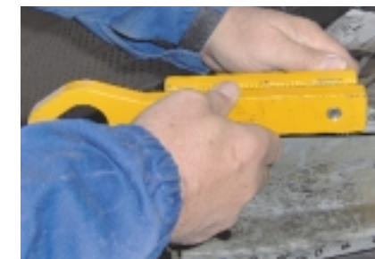
Prostowanie podłużnicy rozpoczynamy od zamocowania odpowiedniego zaczepu (u góry) i wstępnego ustawienia kierunku przykładanej siły (z prawej)
