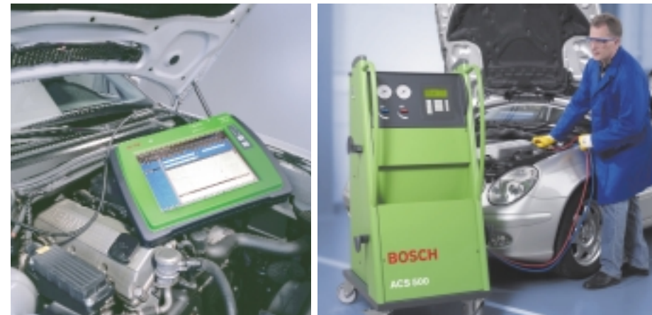
Diagnozowanie klimatyzacji automatycznej wymaga testera z odpowiednim programem. Sam cykl serwisowy przebiega jak w systemach manualnych
