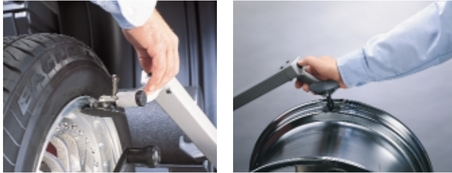
Kontrola osiowej i promieniowej niejednorodności kształtu obręczy
