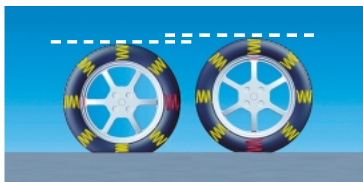
Spłaszczenie opony obciążonej zmniejsza rzeczywisty promień koła
