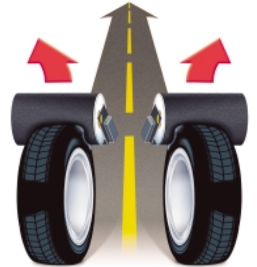
Niejednorodność kształtu opon, np. stożkowe zużycie (z prawej), generuje siły poprzeczne, które mogą wzajemnie się znosić. Na zdjęciu u góry – rolka do kontroli kształtu opony, stanowiąca wyposażenie nowoczesnej wyważarki
