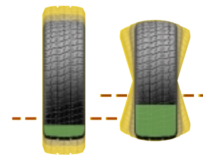
Niewyważenie statyczne i dynamiczne. Żółtym kolorem zaznaczono obszar potencjalnych przemieszczeń
