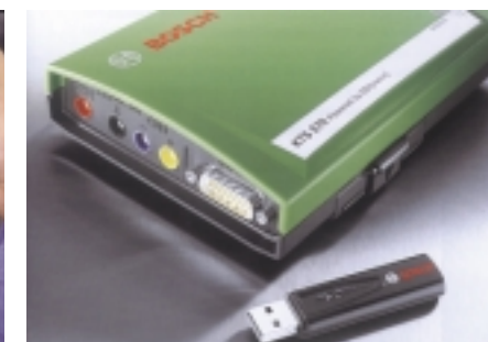
Diagnoskop – przystawka do PC z komunikacją bezprzewodową
