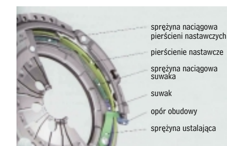
Zasada regulacji dystansu pierścieniami klinowymi
